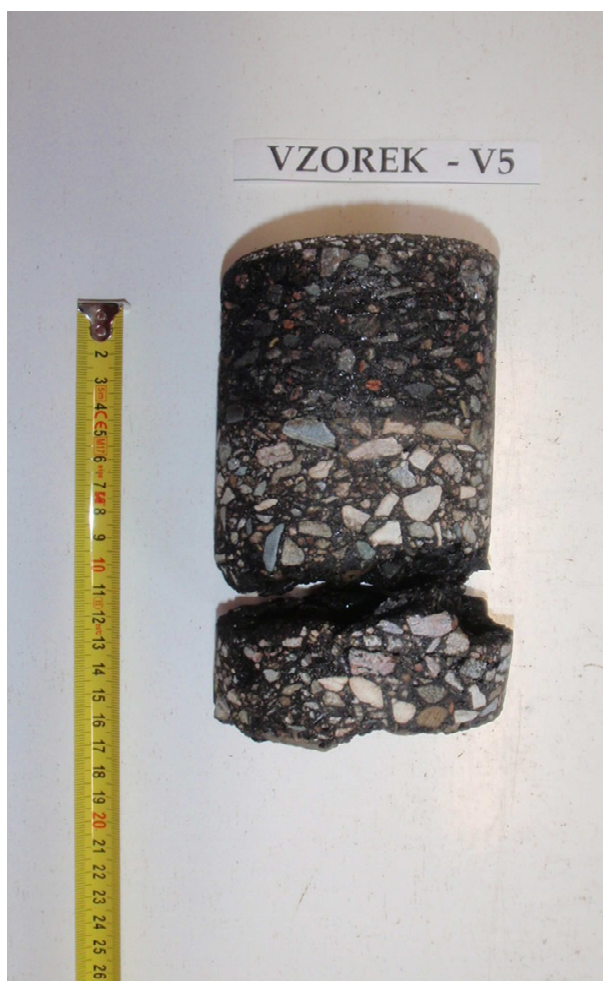
Obr. 10 - Jádro vývrtu Vzorek – V5 (laboratoř).
