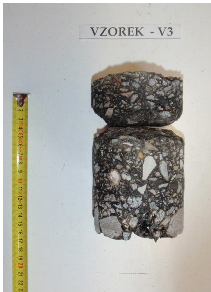
Obr. 6 - Jádro vývrtu Vzorek – V3 (laboratoř).
