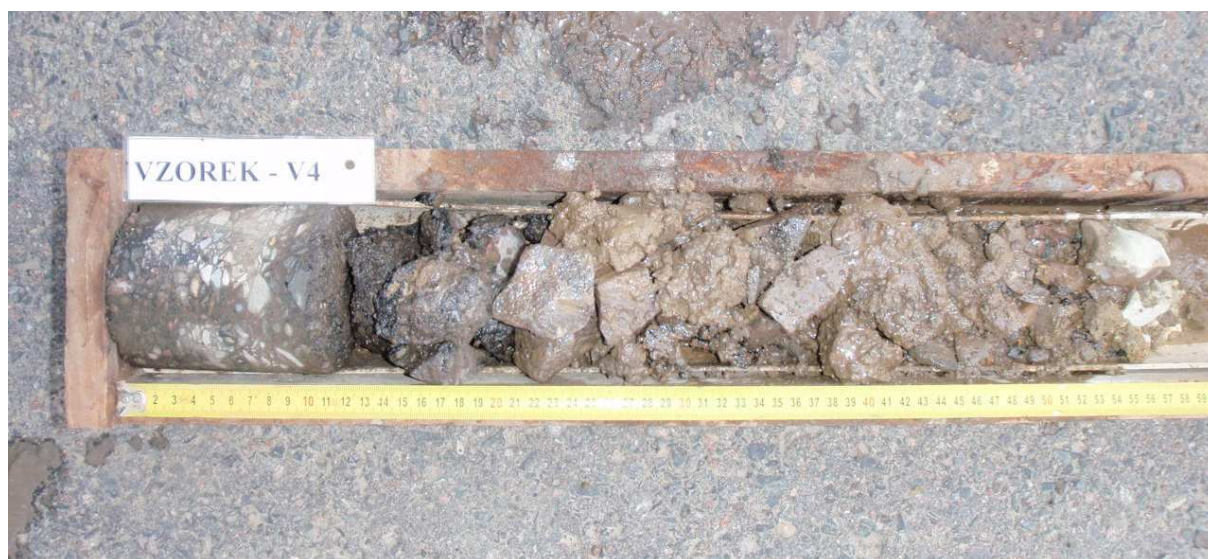
Obr. 7 - Jádro vývrtu Vzorek – V4 (in situ).
