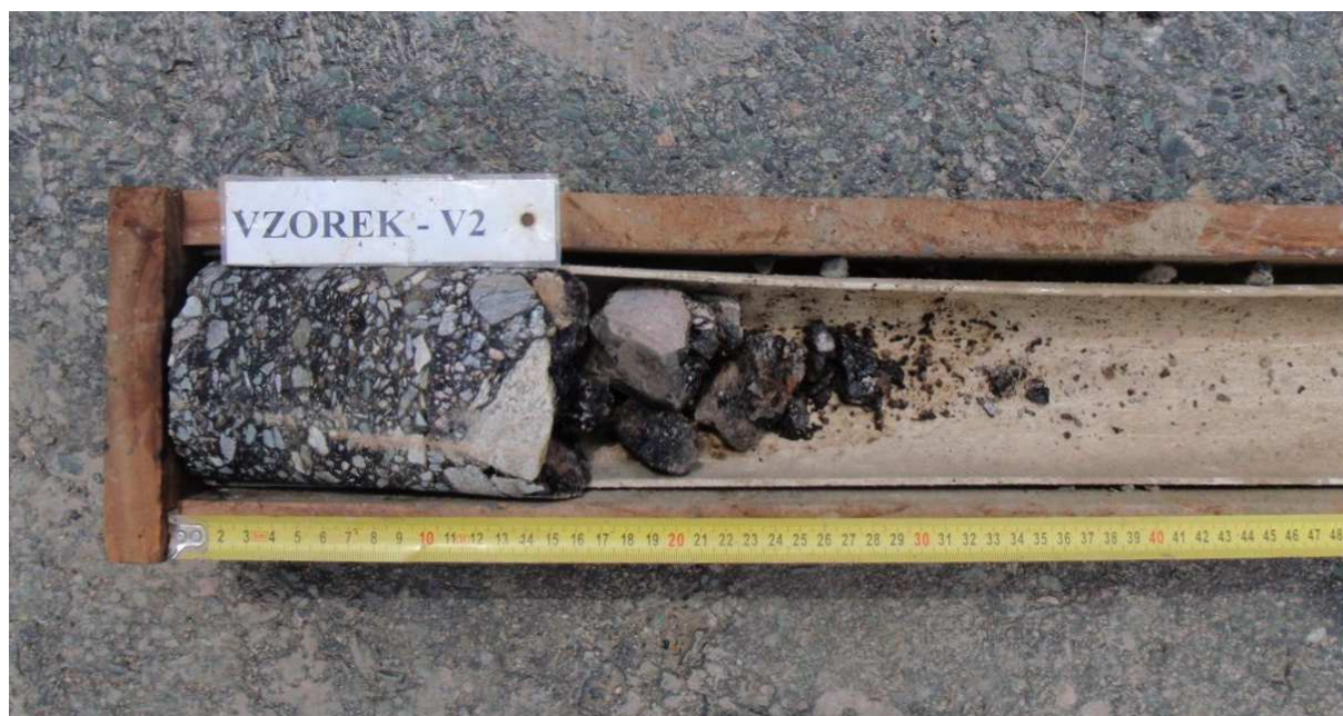
Obr. 3 - Jádro vývrtu Vzorek – V2 (in situ).
