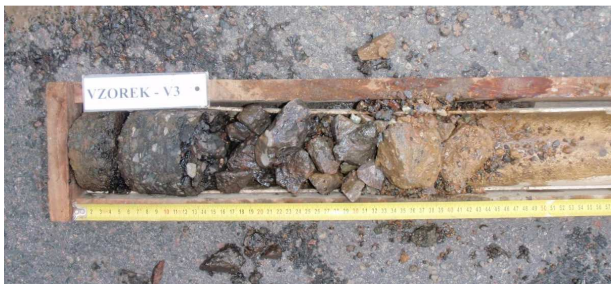
Obr. 5 - Jádro vývrtu Vzorek – V3 (in situ).
