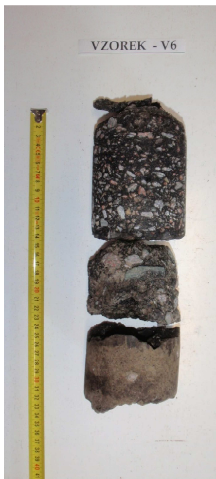
Obr. 12 - Jádro vývrtu Vzorek – V6 (laboratoř).
