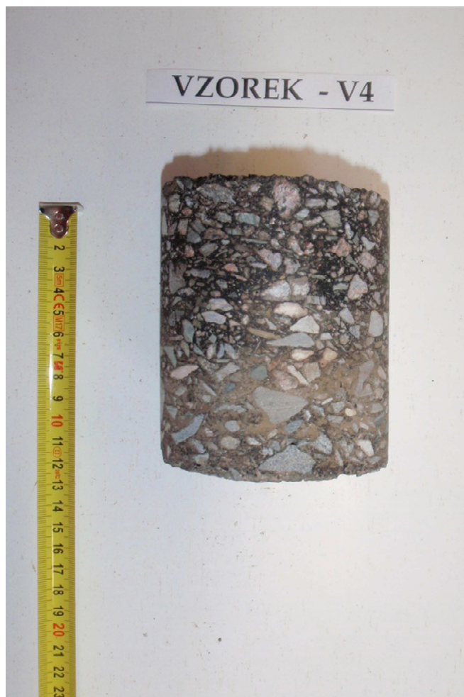
Obr. 8 - Jádro vývrtu Vzorek – V4 (laboratoř).
